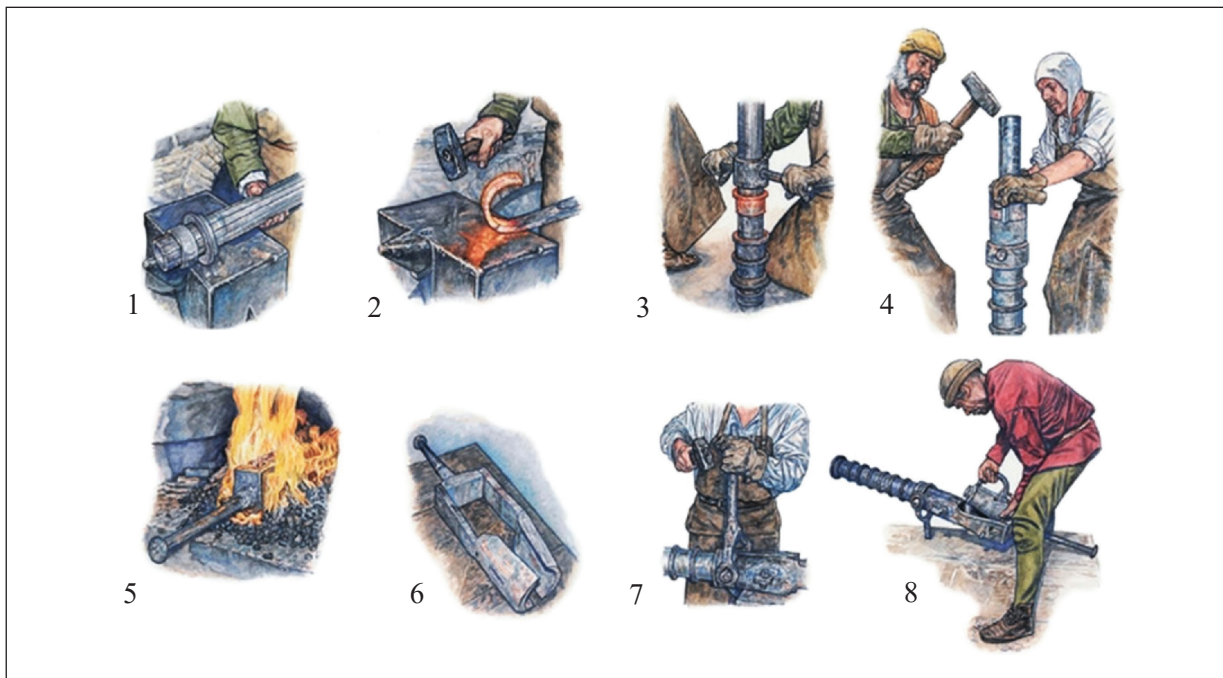
Рис. 1. Процес виробництва кованої гармати (за: Середньовічна... (б.р.))
