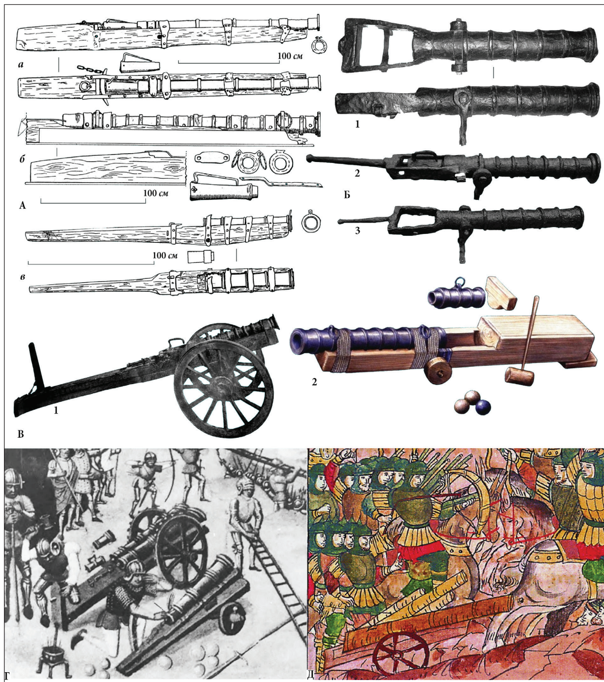
Рис. 2. Вогнепальна зброя (гармати): А — загальний вигляд зверху і збоку залізних казнозарядних гармат типу “instrumentum” кінця XIV — середини XV ст. із вкладеними камерами (калібри: а — 70 мм; б — 105–115 мм; в — 95 мм) (за: Арендт 1935, с. 298–302); Б — казнозарядні гармати: 1 — Запорізький краєзнавчий музей (за: Шаповалов 2008, фото 1–3); 2–3 — музей історії зброї в м. Запоріжжя (фото автора); В — 1 — гуфниця на колісному лафеті (за: Stepiński, Żabiński, Strzyż 2013, fig. 30); 2 — кована гармата з камерою заряджання (за: Середньовічна... (б. р.)); Г — облога фортеці з використанням казнозарядних гармат. Фрагмент мініатюри з французького манускрипту «Histoire de Charles Martel», близько 1470 р. (за: Носов 2010, с. 65); Д — «Пушки и пищали» литовсько-руського війська в 1399 р. Фрагмент мініатюри Лицевого зводу XVI ст. (за: Кирпичников 1976, табл. XXIX: 2)
