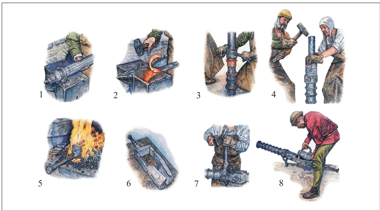
Рис. 1. Процес виробництва кованої гармати (за: Середньовічна... (б.р.))
